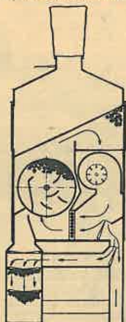
Fig. 9. Schema de lucru a uscătoriei numai cu tambur, model dr. Messer-Schilde.
