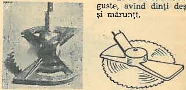
Fig. 1. Organul activ al ferăstrăielor cu discuri circulare, folosite la executarea operațiunilor culturale.
