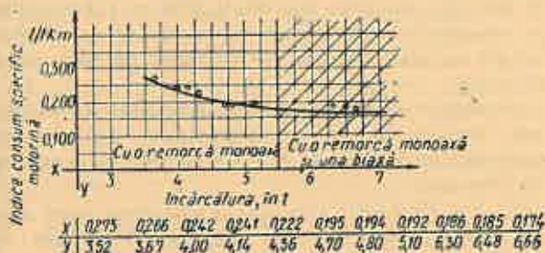
Fig. 5. Diagrama variației indicelui de consum specific de motorină raportat la tona kilometrică, în funcție de încărcătură.
