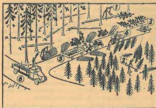
Fig. 9. Sistemul de mașini pentru lucrările de curățire a deșeurilor:
