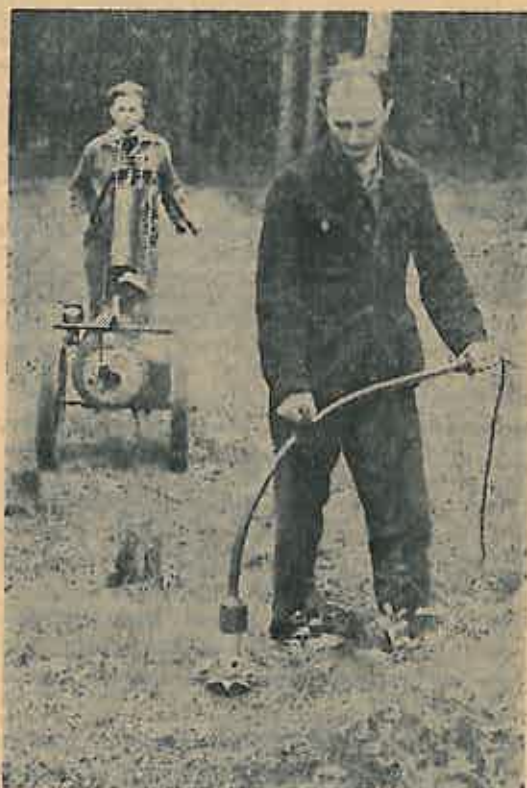
Fig. 3. Aparat electric portabil pentru degajarea seminșului. Pe tractorul monoax se montează un generator care furnizează curentul electric.
