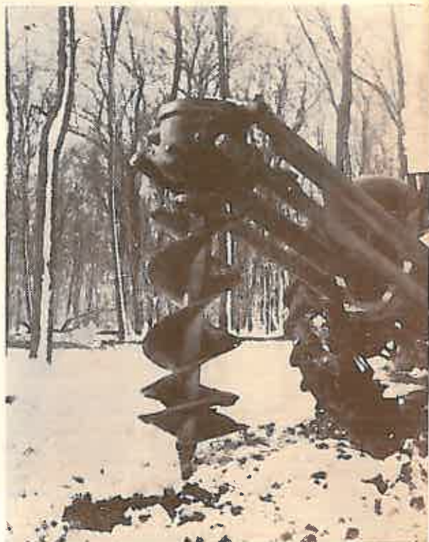
Burghiul românesc de făcut gropi cu diametrul de 600 mm, montat pe tractorul UTOS-27
