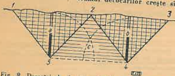
Fig. 8. Derocări de degajare cu două găuri de mină.
