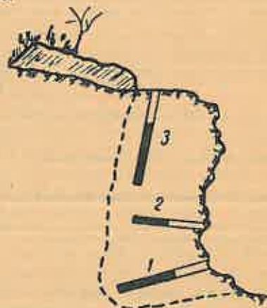
Fig. 2. Poziția găurilor de mină: 1 - găuri de fund sau marginale; 2 - găuri intermediare; 3 - găuri frontale.
