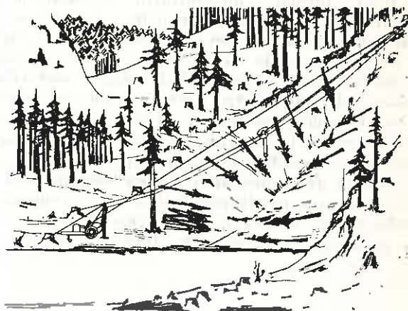
Fig. 4. Colectarea în aval a lemnului brut cu funicularul FUMO-403.
