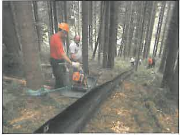
Fig. 8. Instalație de alunecare Leikam Logline
