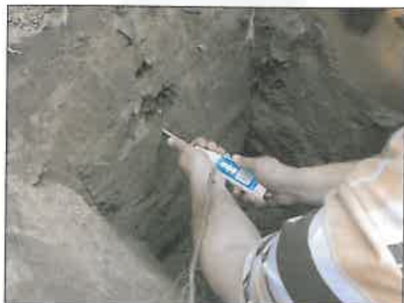
Fig. 2. Măsurarea umidității momentane a solului cu umidometru Lutron PMS-714.
