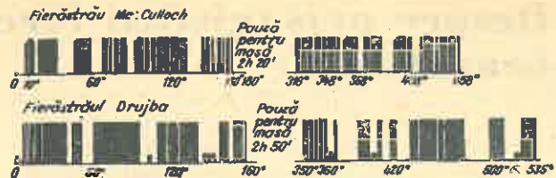
Fig. 1. Variațiile timpului de expunere a motoristilor la CO din gazele de eșapament la două tipuri de ferăstraie mecanice.
