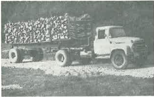
Fig. 2. Autotren forestier SR-115, cu trolu TA-2AM și cu remorcă modernizată, dotat cu containere pentru încărcarea mecanică a lemnului rotund și despiciat (8—10 TF).
